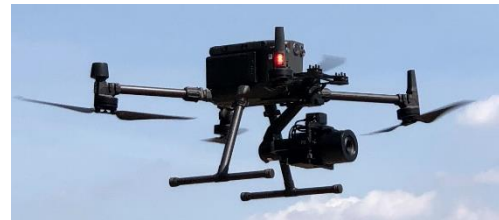
รูปที่ 5 DJI Mavic 300 with Phase One iXM-100
