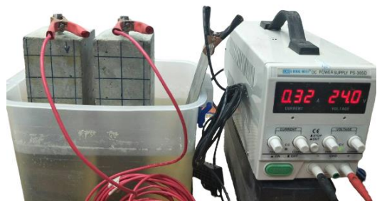
รูปที่ 2 ลักษณะการต่อวงจรไฟฟ้าเพื่อดำเนินการเร่งสนิมของเหล็กเสริมในคอนกรีต
