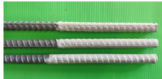
รูปที่ 1 ลักษณะการเคลือบเหล็กข้ออ้อยด้วยวัสดุเคลือบผิว
