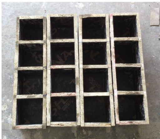
รูปที่ 6 แบบหล่อตัวอย่างคอนกรีตขนาด 10 x 10 x 10 ลบ.ซม.
