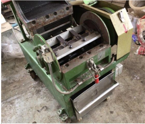
รูปที่ 5 เครื่องบดพลาสติกพร้อมตะแกรงคัดขนาด
