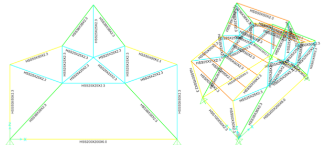
รูปที่ 13 ผลลัพธ์การหาขนาดชิ้นส่วนโครงสร้างด้วยโปรแกรม SAP2000
