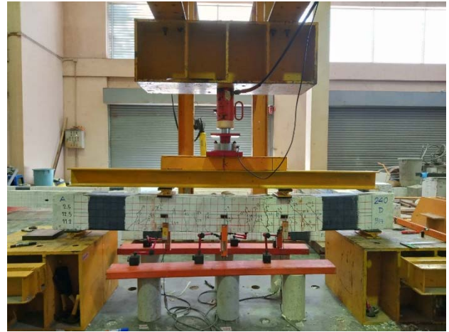
รูปที่ 5 คานเสริมกำลัง FB-1D-2.5h เมื่อหยุดให้น้ำหนักบรรทุกกระทำ
