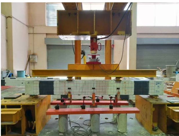
รูปที่ 4 คานเสริมกำลัง FB-1D-2.5h ก่อนให้น้ำหนักบรรทุกกระทำ
