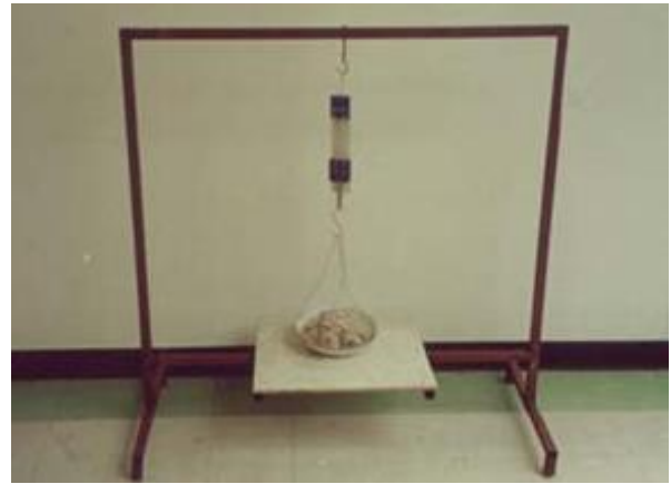
รูปที่ 9 เครื่องทดสอบการรับกำลังแรงดึงของรากกระถินเทพา
