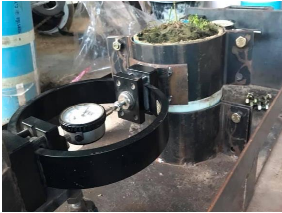
รูปที่ 11 เครื่องทดสอบการรับกำลังแรงเฉือนของดินที่เสริมกำลังด้วยรากกระถินเทพา (ด้านข้าง)
