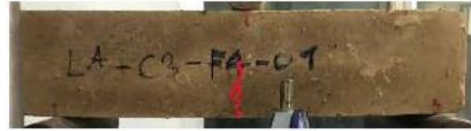
เส้นใยเหล็กยางรถยนต์ 4% ความยาวรอยร้าว 4.5 ซม.
