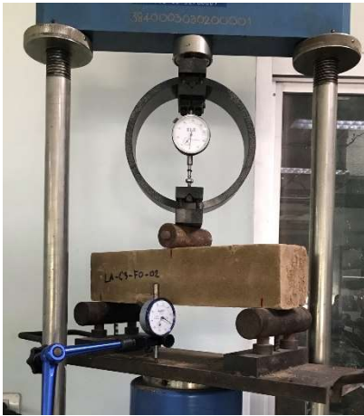
รูปที่ 11 การทดสอบการรับกำลังแรงดัดของคาน
