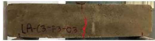
เส้นใยเหล็กยางรถยนต์ 3% ความยาวรอยร้าว 6 ซม.
