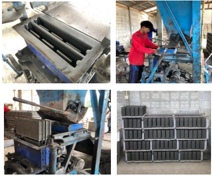
รูปที่ 1 แบบหล่ออิฐบล็อกคอนกรีต การอัดอิฐบล็อกคอนกรีตและตัวอย่างทดสอบอิฐบล็อกคอนกรีต
