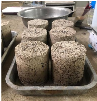
รูปที่ 9 การทดสอบ Water absorption ของวัสดุชั้นทางที่ปรับปรุงด้วยคุณภาพซีเมนต์ผสมกับแอสฟัลต์อิมัลชัน
