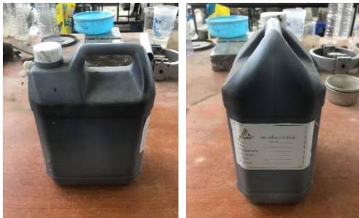
รูปที่ 1 Asphalt Emulsion (CSS -1) หรือยางมะตอยน้ำ CSS-1h (Cationic Slow Setting)
