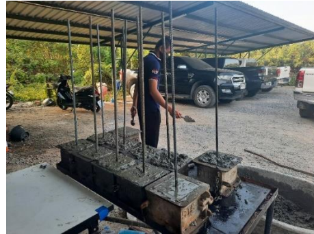
รูปที่ 6 หล่อคอนกรีตตัวอย่าง
