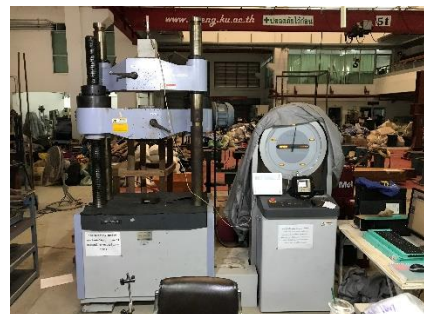
รูปที่ 12 เครื่องทดสอบแรงดึง (Universal Testing Machine)
