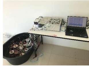
รูปที่ 16 การทดสอบเร่งปฏิบัติการกัดกร่อนให้เกิดสนิม
