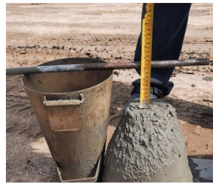
รูปที่ 2 ทดสอบหาค่าการยุบตัวของคอนกรีต
