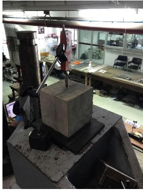
รูปที่ 13 ติดตั้ง Dial gauge วัดระยะการเคลื่อนที่ของเหล็กเสริม
