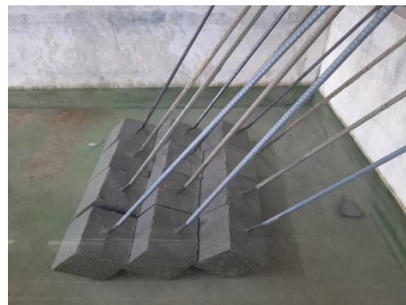
รูปที่ 7 บ่มตัวอย่างคอนกรีตโดยการแช่น้ำ
