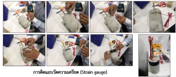
การติดแถบวัดความเครียด (Strain gauge)
