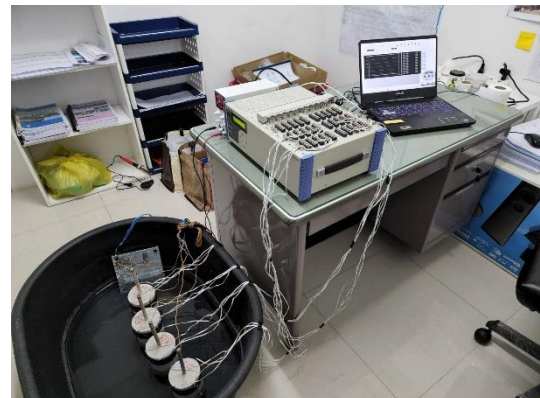
รูปที่ 10 การทดสอบแรงปฏิบัติการไฟฟ้าเคมีเพื่อเร่งการเกิดสนิมในเหล็กเสริม
