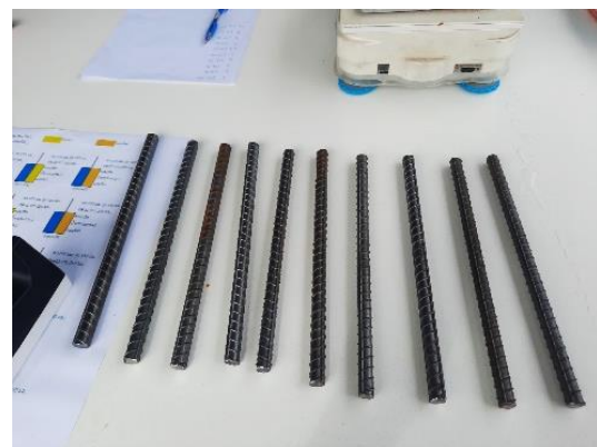
รูปที่ 2 เหล็กข้ออ้อยขนาด 12 มิลลิเมตร ความยาว 250 มิลลิเมตร
