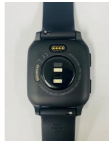
รูปที่ 4 เซนเซอร์วัดอัตราการเต้นของหัวใจด้านหลังเครื่องวัด
