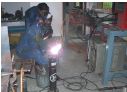
รูปที่ 4 แสดงกระบวนการเชื่อมด้วยลวดเชื่อมหุ้มฟลักซ์
