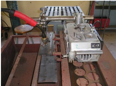
รูปที่ 3 การประกอบหัวเชื่อมเพื่อทำการเชื่อมแบบกึ่งอัตโนมัติ
