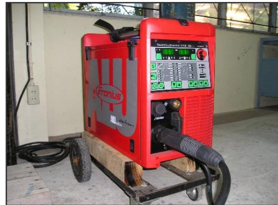
รูปที่ 2 เครื่องเชื่อมที่ใช้ในการเชื่อมทดลอง
