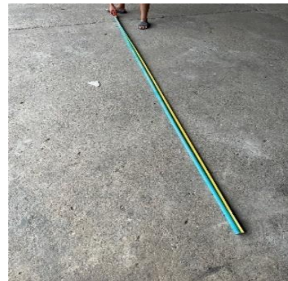
รูปที่ 9 การกำหนดระยะในน้ำในการวัดสอบเครื่องมือหยั่งความลึก
