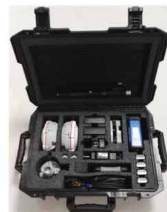
รูปที่ 3 เครื่องมือรังวัดด้วยดาวเทียม Sino GNSS T300 GNSSRECEIVER ที่มา : ( https://www.comnavtech.com/T300.html )
