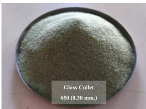
รูปที่ 3 ลักษณะเศษแก้วที่ผ่านการย่อยและร่อนผ่านตะแกรง
