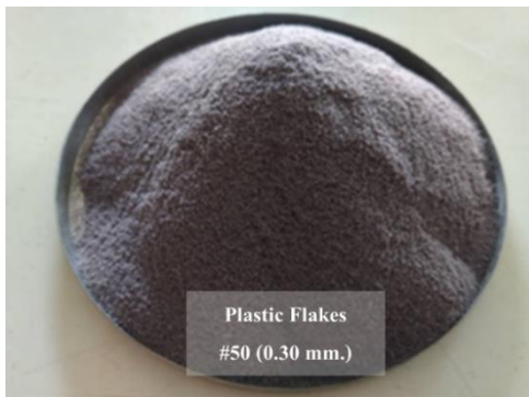
รูปที่ 2 ลักษณะเกล็ดพลาสติกที่ผ่านการย่อยและร่อนผ่านตะแกรง
