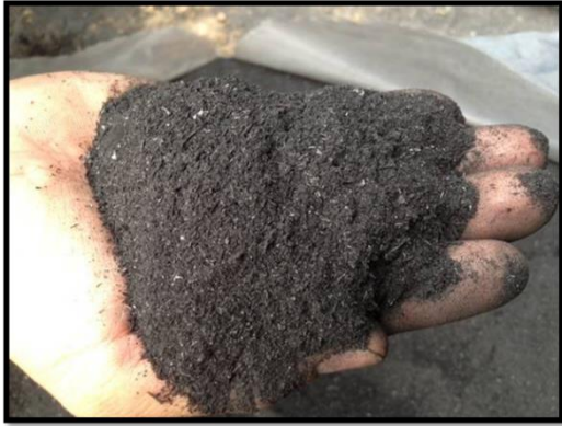
รูปที่ 1 แกลบที่มีขนาดของเม็ดผ่านตะแกรงเบอร์ 200
