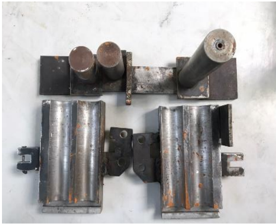
รูปที่ 3 แบบหล่อ (Mold) ที่ใช้ในการทดสอบ
