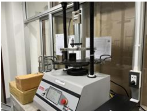
รูปที่ 6 การติดตั้งแผ่นตัวอย่างสำหรับทดสอบมอดูลัสแตกหักแผ่นซีเมนต์บอร์ด
