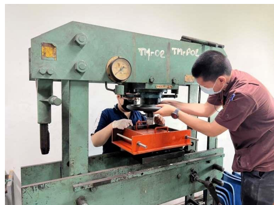
รูปที่ 4 การติดตั้งชุดเครื่องมือที่พัฒนาขึ้นกับเครื่องอัดไฮโดรลิกขนาด 30 ตัน
