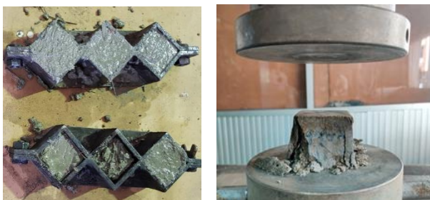
รูปที่ 6 แสดงการทดสอบค่ากำลังอัดมอร์ต้าซีเมนต์ผสมใบจาก
