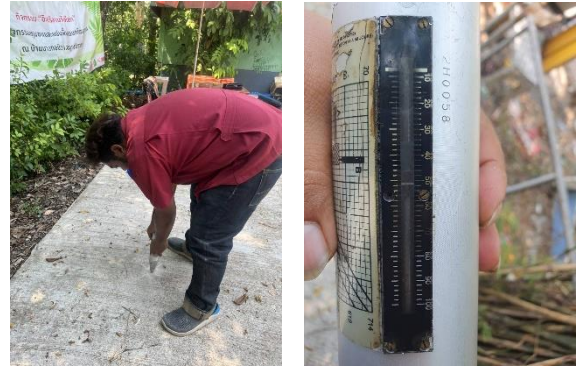
รูปที่ 7 แสดงการทดสอบค่ากำลังอัดแบบไม่ทำลายในภาคสนาม
