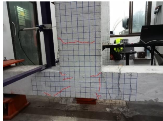
รูปที่ 10 ความเสียหายของชิ้นงานทดสอบ JC หลังการทดสอบ
