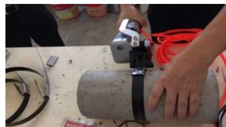
รูปที่ 3 การรัดรอบตัวอย่างด้วยวิธี Post-tensioned metal strapping (PTMS)
