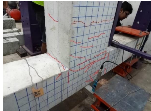
รูปที่ 11 ความเสียหายของชิ้นงานทดสอบ JC-S หลังการทดสอบ
