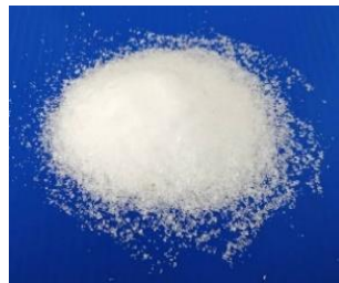
รูปที่ 3 วัสดุพอลิเมอร์ โพลีไวนิลแอลกอฮอล์ (Polyvinyl alcohol, PVA)
