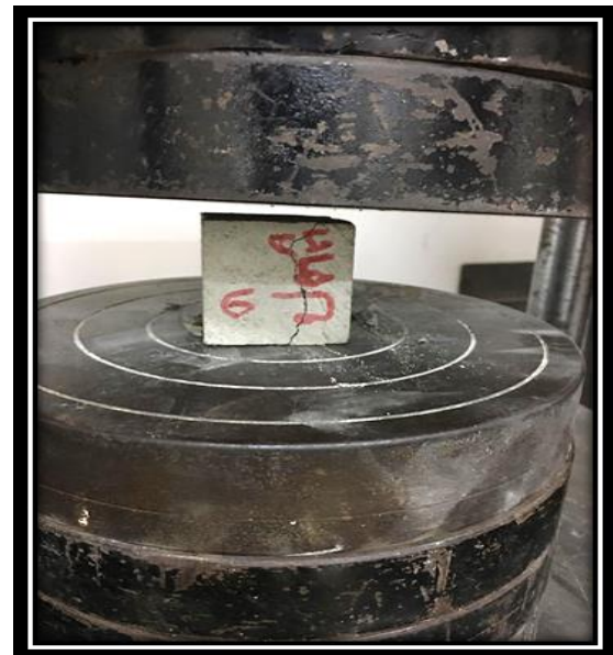
รูปที่ 2 การทดสอบกำลังรับแรงอัดของแท่งตัวอย่าง
