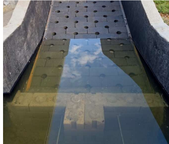
รูปที่ 9 หลังการทดสอบประสิทธิภาพด้านเสถียรภาพการใช้งานของบล็อกเป็นเวลา 4 ชั่วโมง
