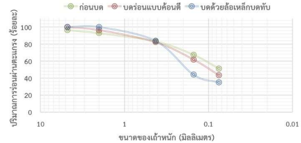
รูปที่ 3 การกระจายของขนาดของเถ้าหนัก ที่ผ่านการบดร่อนแบบค้อนตี และแบบบดด้วยล้อเหล็กบดทับ เมื่อเทียบกับเถ้าหนักก่อนการบด
