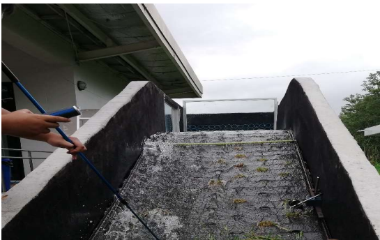
รูปที่ 8 การวัดความเร็วของกระแสน้ำที่ไหลผ่านบนพื้นผิวบล็อกบนอาคารทดสอบ
