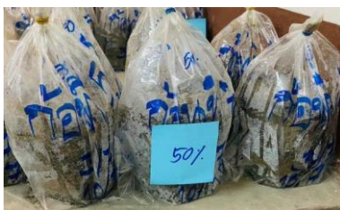
รูปที่ 5 การบ่มตัวอย่าง
