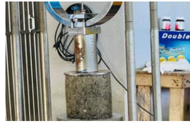
รูปที่ 6 การทดสอบ UCS
