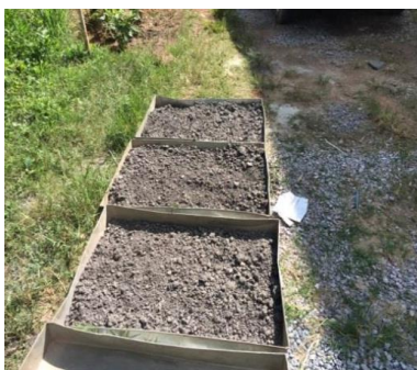
รูปที่ 1 ตัวอย่างที่แอสฟัลต์คอนกรีตเก่า (RAP) ที่ใช้ทดสอบ
