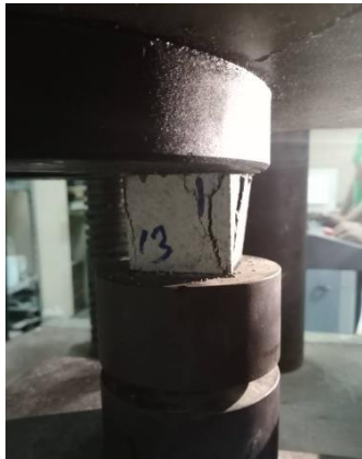
รูปที่ 2.5 การทดสอบหาความต้านทานแรงอัดของซีเมนต์มอร์ตาร์
