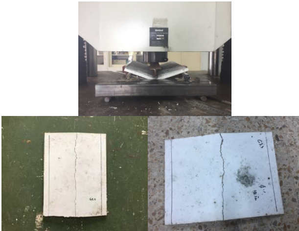
รูปที่ 11 การทดสอบการแตกหักของชิ้นงาน
