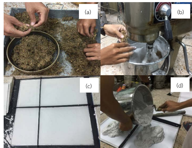
รูปที่ 5 ขั้นตอนการทำแผ่นยิปซัมฝ้าเพดานตัวอย่าง
