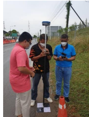
รูปที่ 9 การรังวัดค่าพิกัดจุดควบคุมภาคพื้นดินด้วยวิธีการ RTK
