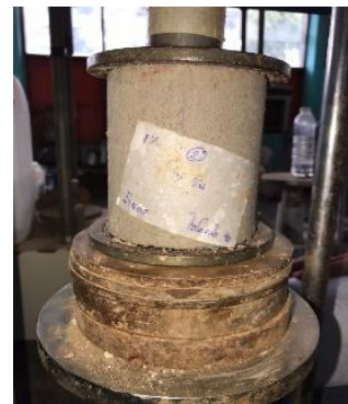
รูปที่ 6 การทดสอบกำลังอัดแบบไม่ถูกจำกัด
