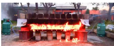
รูปที่ 5 การทดสอบให้น้ำหนักบรรทุกคงค้างและไฟ [18]
