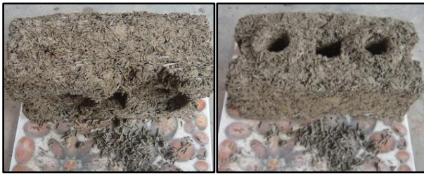
รูปที่ 8 บล็อกประสานปรับปรุงด้วยแกลบที่แตก่วนภายหลังจากอัดขึ้นรูป
