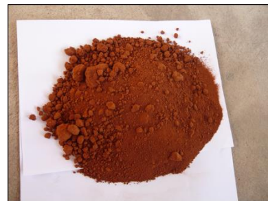
รูปที่ 1 ลักษณะทางกายภาพของดินที่ใช้ผลิตบล็อกประสาน
