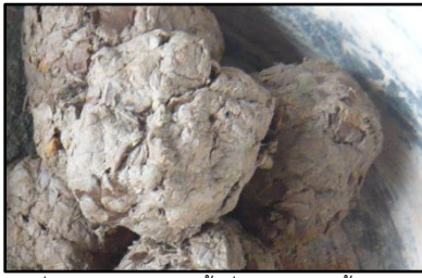
รูปที่ 2 กระดาษเหลือทิ้งที่ผ่านการแช่น้ำสองวัน
