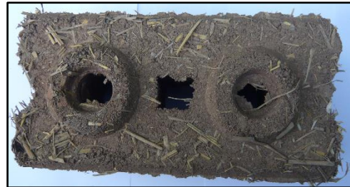
รูปที่ 11 บล็อกประสานปรับปรุงด้วยฟาง 0.1 กิโลกรัม
