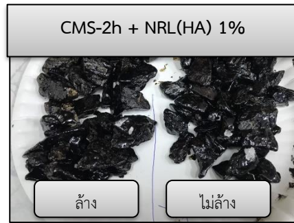
รูปที่ 11 แอสฟัลต์อิมัลชันชนิด CMS-2h + NRL(HA) 1%
