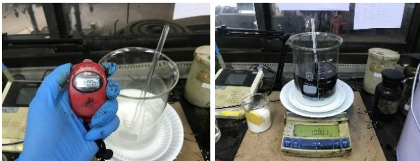
รูปที่ 5 การผลิตแอสฟัลต์อิมัลชันผสมน้ำยางพาราธรรมชาติเข้มข้น
