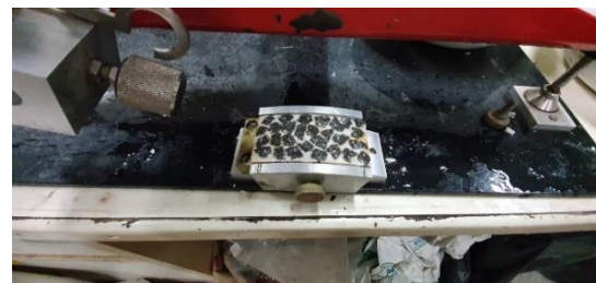
รูปที่ 9 การทดสอบหาค่า PSV ด้วยเครื่อง BPT ที่ f Unit Scale
