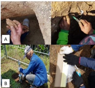
รูปที่ 4 การอัดดินก่อนจากการผสมน้ำเข้าไปยังรูเจาะก่อนการติดตั้งเซ็นเซอร์ (A) และการเก็บตัวอย่างดินแบบคงสภาพ (B)
