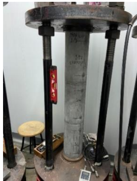
รูปที่ 2 การทดสอบการคืบของคอนกรีต
