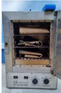
รูปที่ 3 อุปกรณ์ในการบ่มยางด้วยอากาศร้อน
