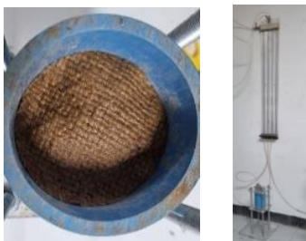
รูปที่ 5 การติดตั้งแผ่นคอมโพสิตและเครื่องทดสอบความชื้นน้ำของดินด้วยวิธีความดันแปรเปลี่ยน
