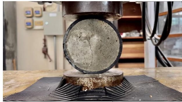
รูปที่ 2 การสร้างรอยร้าวในขึ้นตัวอย่าง
