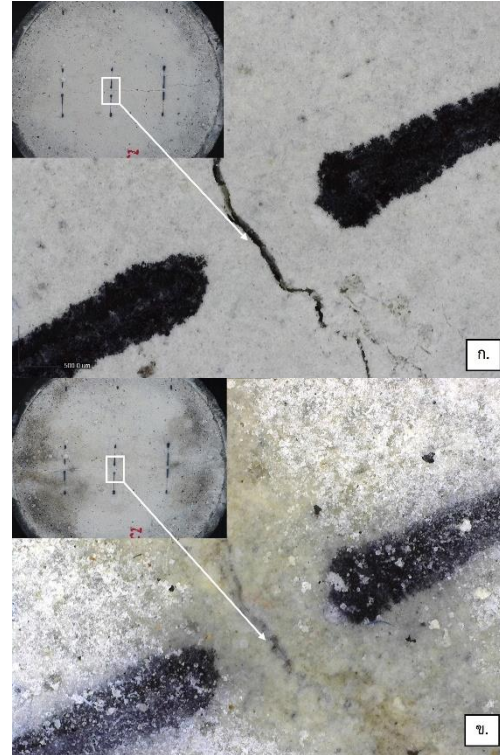
รูปที่ 4 ประสิทธิภาพในการประสานรอยร้าวของตัวอย่าง V1-FC ก. รอยร้าวเริ่มต้น และ ข. รอยร้าวรอบที่ 7 ของการซ่อมแซม
