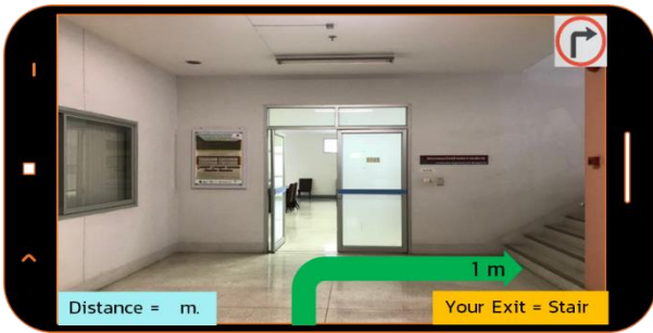
รูปที่ 15 รูปแบบการแสดงผลเส้นทางการอพยพหนีไฟ รูปแบบ 3 มิติ ของระบบอพยพหนีไฟแบบเรียลไทม์ต้นแบบ
