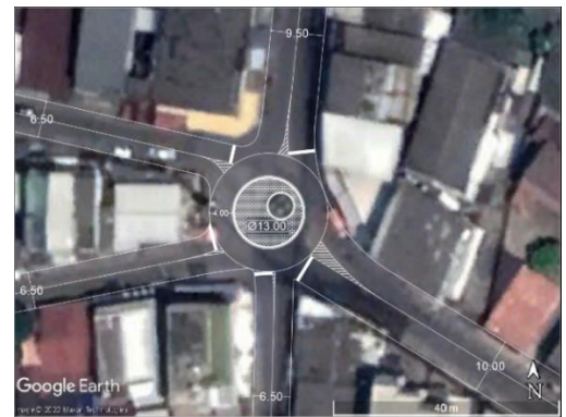
รูปที่ 3.6 การเพิ่มขนาดเกาะกลางของวงเวียน และปรับปรุงลักษณะทางกายภาพของทางเข้าทางแยก
