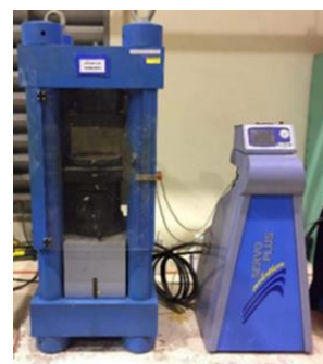
รูปที่ 4 เครื่องทดสอบกำลังรับแรงอัดของมอร์ตาร์
