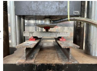
รูปที่ 15 การติดตั้งตัวอย่างบนฐานรองรับในเครื่องทดสอบแรงกด [12]
