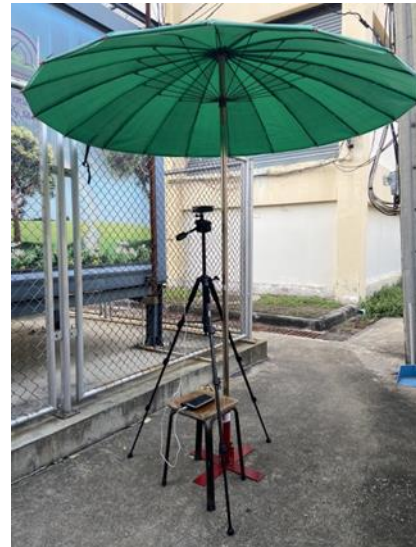
รูปที่ 4 การทดสอบประสิทธิภาพของเครื่องมือวัดมลพิษกับสถานีวัดมลพิษทางอากาศของกรมควบคุมมลพิษ
