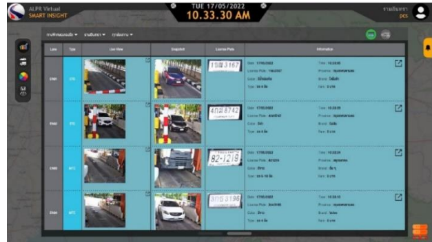
รูปที่ 4 แสดงผลการตรวจจับป้ายทะเบียนและข้อมูลต่าง
