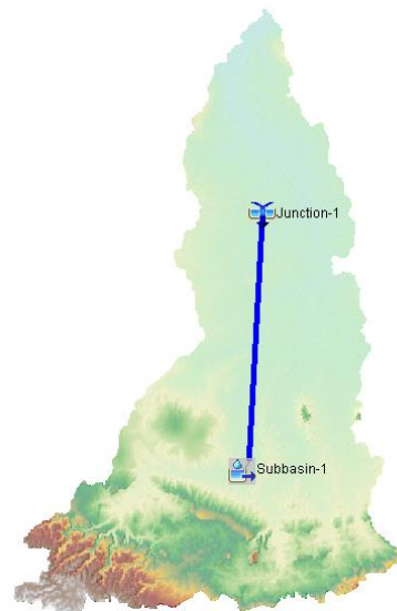
รูปที่ 4 การตั้งค่าแบบจำลอง HEC-HMS ใน Basin Model
