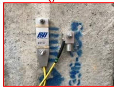
รูปที่ 2 การติดเป้า ArUco ร่วมกับมาตรวัด DLT
