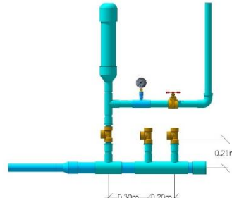
รูปที่ 2 เครื่องตะบันน้ำเพิ่มจำนวนลื่นทิ้งน้ำ 2 ตัวแบบอนุกรม
