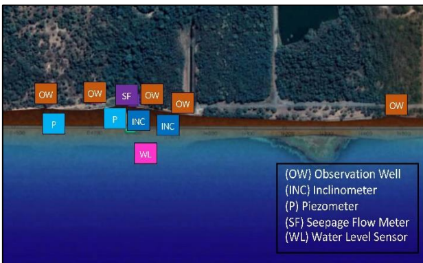
รูปที่ 2 จุดติดตั้งเครื่องมือตรวจวัดพฤติกรรมเขื่อน https://dms.gfe.co.th/
