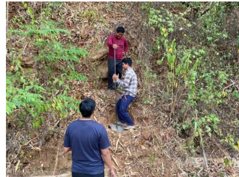
รูปที่ 2 เก็บข้อมูลดินในพื้นที่เชิงลาดโดยใช้วิธีทดสอบดินหยั่งแบบเบา (Kunzelstab Penetration Test)
