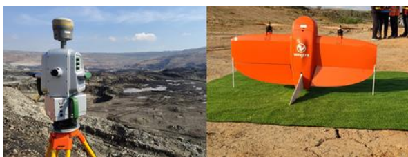
รูปที่ 9 Maptek I-site XR3 (ซ้าย) และ WingtraOne Gen I (ขวา)
