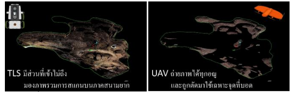
รูปที่ 18 การนำ point cloud จาก UAV มาใช้ในงานรังวัดปริมาตร
