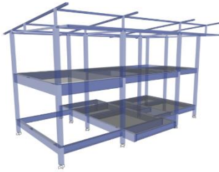
รูปที่ 1 แบบจำลองอาคาร คสล. 2 ชั้น (กว้าง 5.55 ม. ยาว 11.60 ม. สูง 7.10 ม.)
