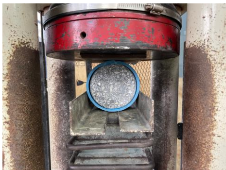
รูปที่ 1 การติดตั้งตัวอย่างทดสอบสำหรับการสร้างรอยร้าว
