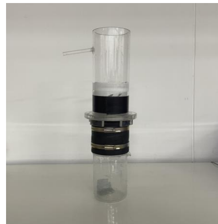
รูปที่ 3 การทดสอบอัตราการไหลของน้ำผ่านรอยร้าว
