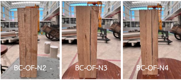
รูปที่ 12 การพิบัติของเสาประกอบไม้อย่างพาราถูกยึดด้วยตะปู (รูปแบบที่ 1)
