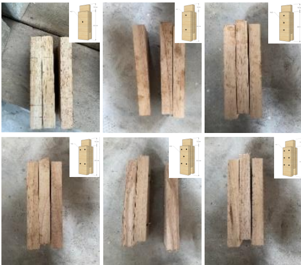
รูปที่ 16 การพิบัติของไม้อย่างพาราในการทดสอบการรับแรงเฉือนของตะปู
