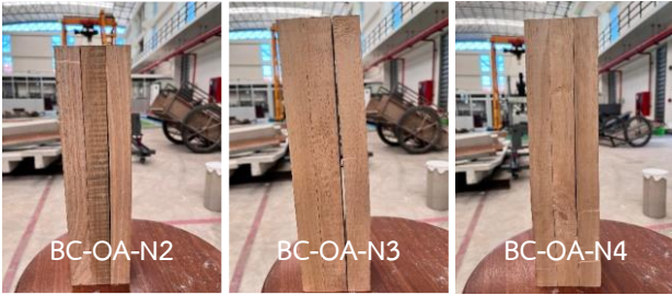
รูปที่ 14 การพิบัติของเสาประกอบไม้อย่างพาราถูกยึดด้วยตะปู (รูปแบบที่ 3)
