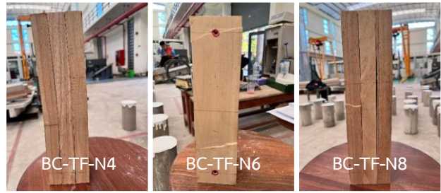
รูปที่ 13 การพิบัติของเสาประกอบไม้อย่างพาราถูกยึดด้วยตะปู (รูปแบบที่ 2)
